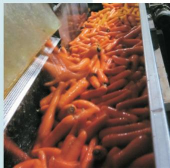
En aplicaciones donde tradicionalmente se usan bandas modulares para el lavado, drenado y transporte de vegetales, la suciedad, tierra y piedras, saturan en poco tiempo tanto los huecos de la banda modular como sus articulaciones (ver foto).
