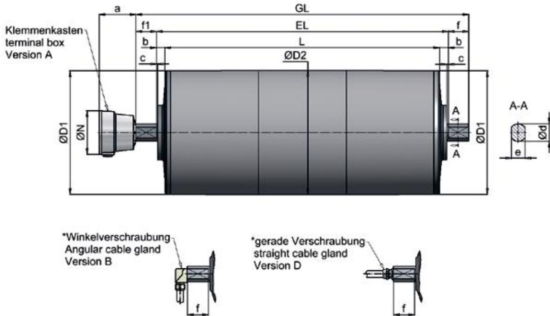
**Umlenktrummel / Guide Drum Motor Typ UT 321**
