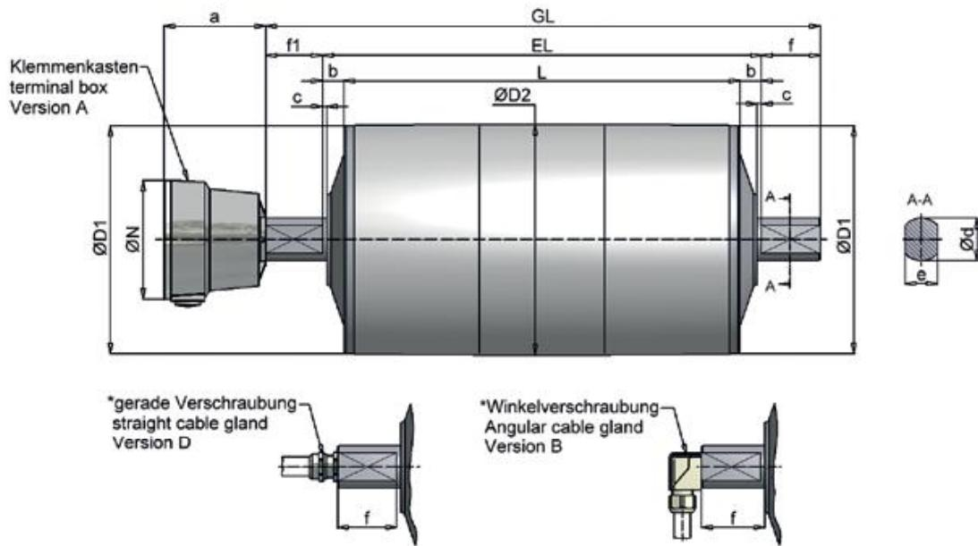
**Umlenktrummel / Guide Drum Motor Typ UT 216**
