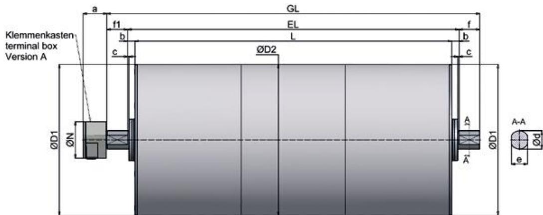
**Umlenktrummel / Guide Drum Motor Typ UT 620**
