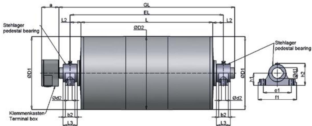
**Umlenktrummel / Guide Drum Motor Typ UT 630**
