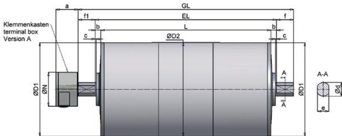
**Umlenktrummel / Guide Drum Motor Typ UT 415**
