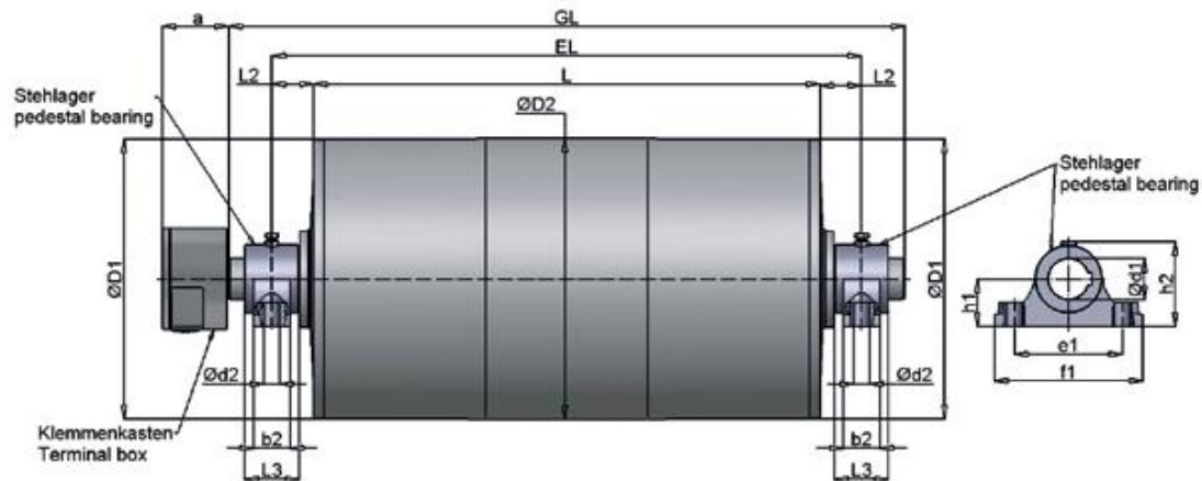
**Umlenktrummel / Guide Drum Motor Typ UT 160 - UT 620**
