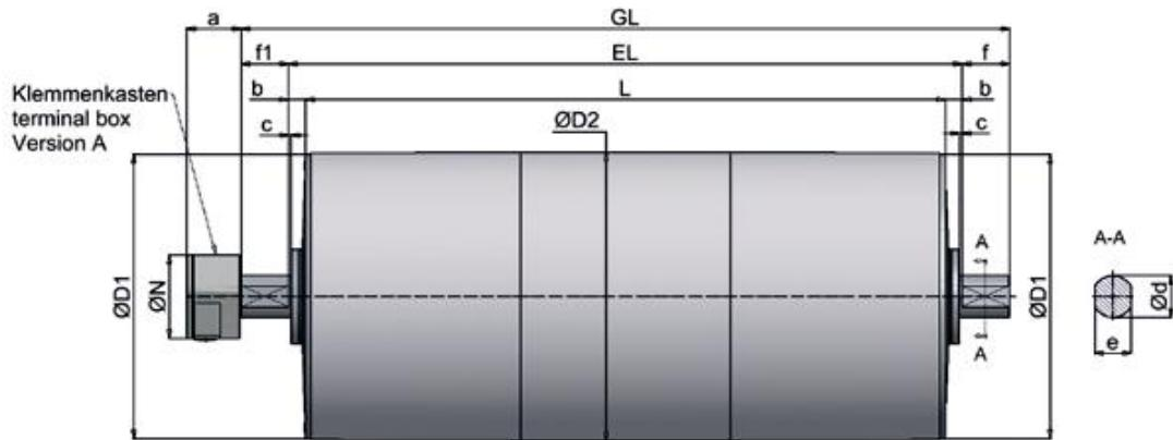
**Umlenktrummel / Guide Drum Motor Typ UT 518**
