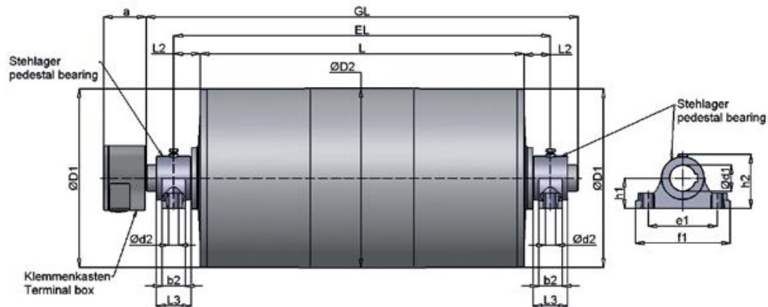
**Umlenktrummel / Guide Drum Motor Typ UT 800**
